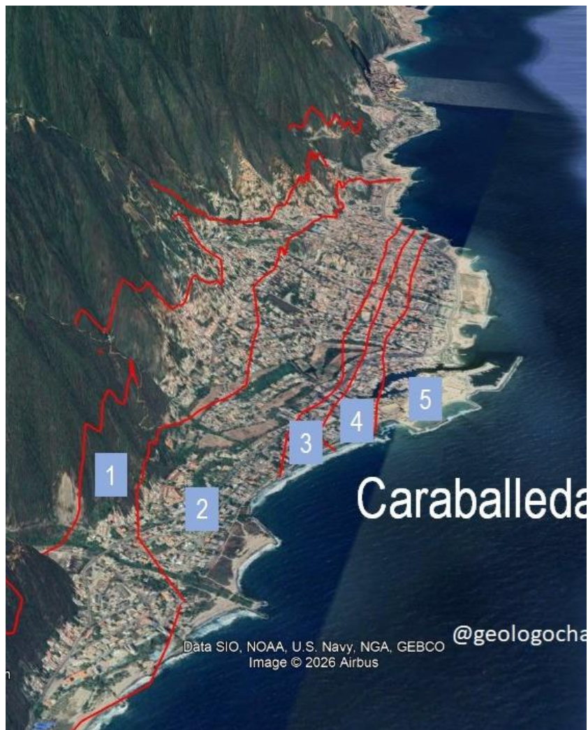
Figura 8. Integración del mapa isópaco de profundidad del basamento rocoso georreferenciado sobre imagen satelital de Google Earth Pro en el abanico aluvial de Caraballeda (Estado La Guaira). Los contornos definen los rangos de espesor sedimentario desde facies someras (0-50 m) hasta el depocentro máximo (350-450 m) en Punta Caraballeda.
